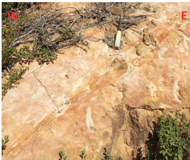
Figura 4.10 – Fracturação a afectar sedimentos da formação de Alvalade ao km 48,8 do IC33 (38°11'50'' N/8°36'31'' W).
