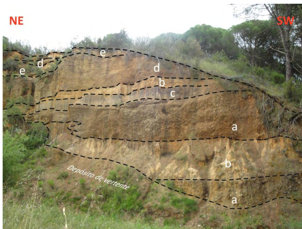
Figura 3.10 – Afloramento da formação de Melides no barranco do Brejo, zona de Melides (figura 3.1, 9; 38°9'14'' N/8°42'55'' W). Litologias descritas no texto. Corte com ≈ 30 m de altura máxima.
